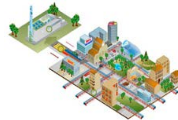
Esquema de la red de distrito en el que se muestran los elementos principales (central, red y consumidores) / ADHAC
