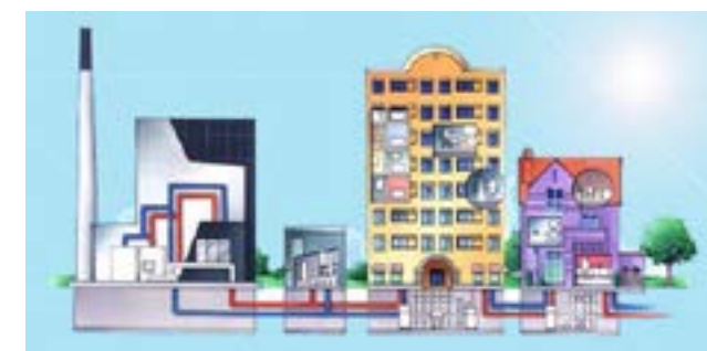
Esquema simple de climatización colectiva en red de distrito / ADHAC
